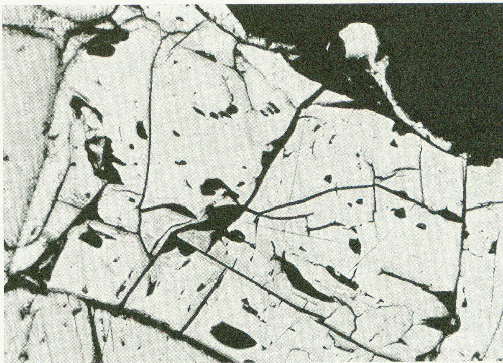
Fig. 4. Vergesellschaftung von Magnetkies (grau) und Pentlandit (hell) mit Bravoiitbildungen (hellgrau) in violetter Hornblendeperidotit, Valle di Capolo. Vergr. 180×.
