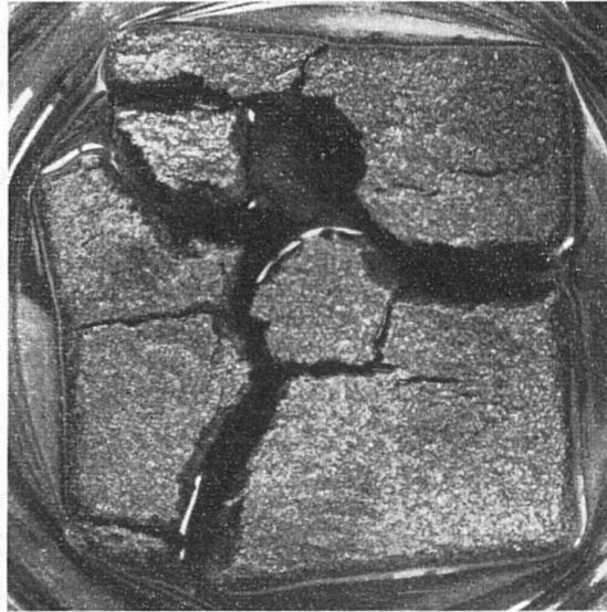
Fig. 9. Sandstein vom Typus C kurz nach dem direkt beobachtbaren rasch verlaufenen Zerbersten (in Lösung). Das Zentrum der Probe bestand aus völlig lockerem Sand, der durch die Treibrisse ausfloss.
