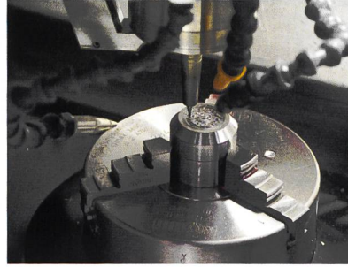
Abb. 38/39: Links: Die Modelle von Bild- und Wertseite in gelbem bzw. weissem Kunststoff, Durchmesser 200 mm; rechts: Fräsen der Reduktion der Zweifranken-Wertseite ab den digitalen Daten.
