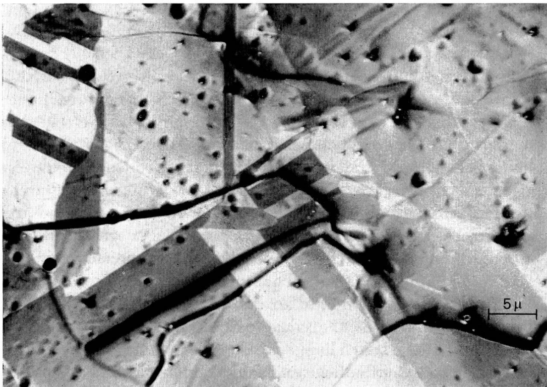
Abb. 12 Aufnahme derselben Objektstelle wie Abb. 11 nach Aufheizen des Objektes auf 350° C. Sichtbarwerden der Rekristallisation in Photoemission bei unverändertem Oberflächenrelief.
