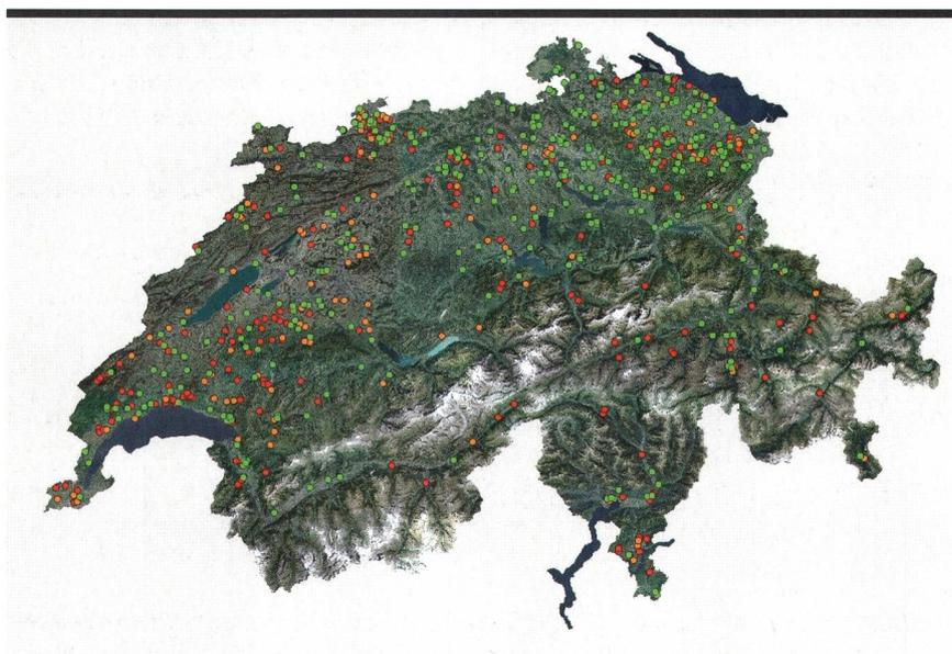
Geografische Verteilung der untersuchten PV-Anlagen mit Einfärbung der Abweichung vom Mittelwert über alle Anlagen: grün: +2% oder mehr; orange: -2 bis +2%; rot: -2% oder mehr).
