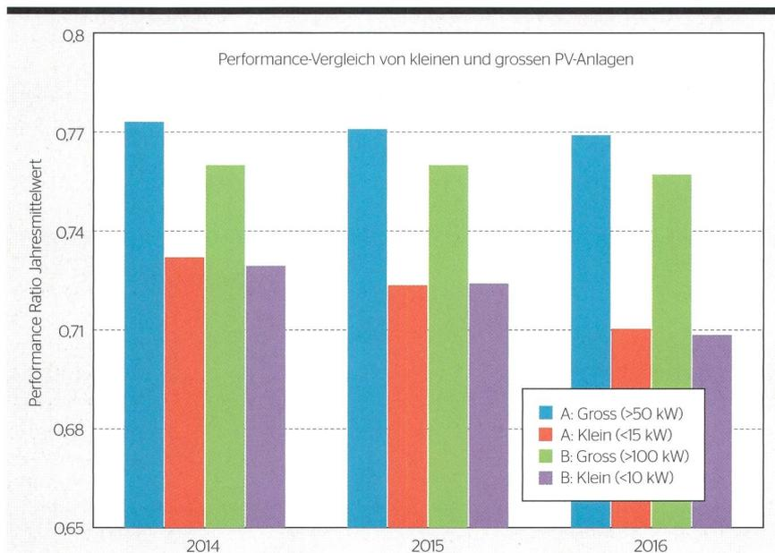
Unterschiede in der Performance Ratio zwischen kleinen und grossen PV-Anlagen von 4-8 % konnten über unterschiedliche Samples und Zeiträume nachgewiesen werden.
