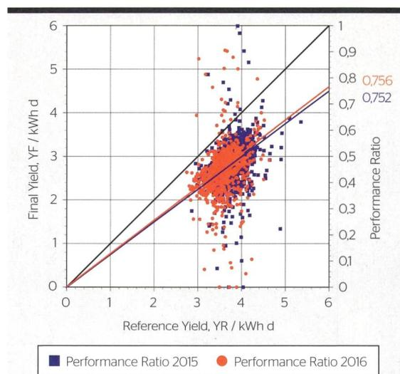
Vergleich der Jahres-Performance-Ratio für die Jahre 2015 und 2016. Die Punkte stellen einzelne PV-Anlagen dar: Rote Punkte sind Werte 2016, blaue Werte 2015.
