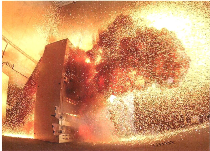
Störlichtbogenprüfung ohne Schutzmassnahmen.
