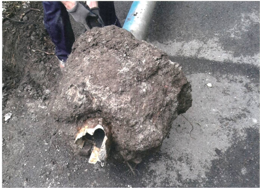
Eine Schwachstelle im Erdreich führte zum Kippen des Kandelabers.
