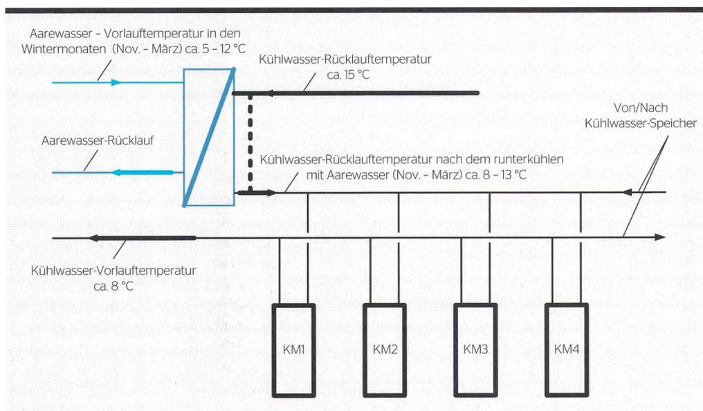
Schema der Aarewasserkühlung: Im Winter wird das Kühlwasser vor dem Eintritt in die Kältemaschinen mit Aarewasser vorgekühlt. Der Energieverbrauch wird damit um fast 25 % verringert.
