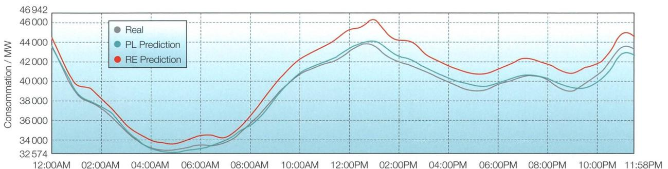
**Figure 3** Modèle prévoyant la consommation d'énergie électrique de la France au jour  $J+1$  en fonction, notamment, des données historiques et des prévisions météorologiques. La prédiction de Predictive Layer (PL) atteint une erreur moyenne de 0,82 % alors que la prédiction standard (RE) s'élève à 3,57 %.
