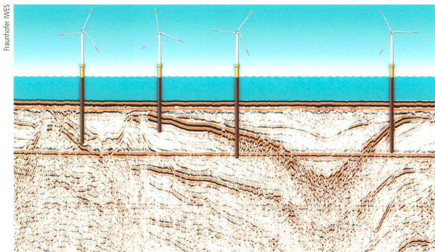
Ein mehrkanalseismisches Profil zeigt den Verlauf von Bodenschichten.
