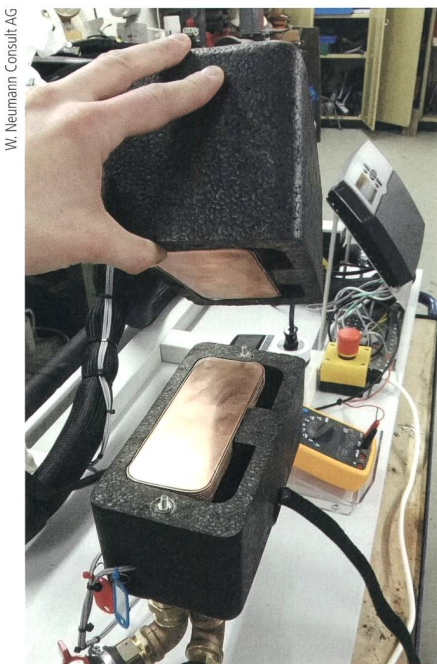
Demonstrator mit 1 kW thermischer Übertragungsleistung, wie er im Kontext mit der BFE-Studie zur Thermoelektrik gebaut wurde. Im Bild: Geteilter Wärmetauscher zur Aufnahme eines thermoelektrischen Elements.
