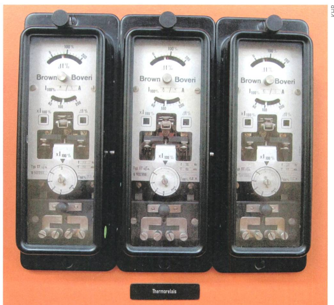
Bild 4 Thermisches Überstromrelais ST, BBC.
