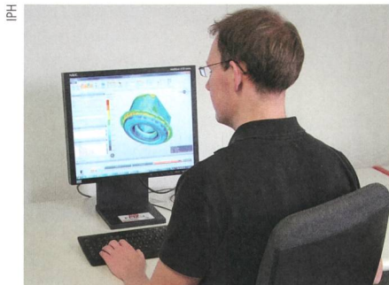
Mittels FEM-Simulation testet dieser IPH-Ingenieur die Umformung eines Stahlkolbens.
