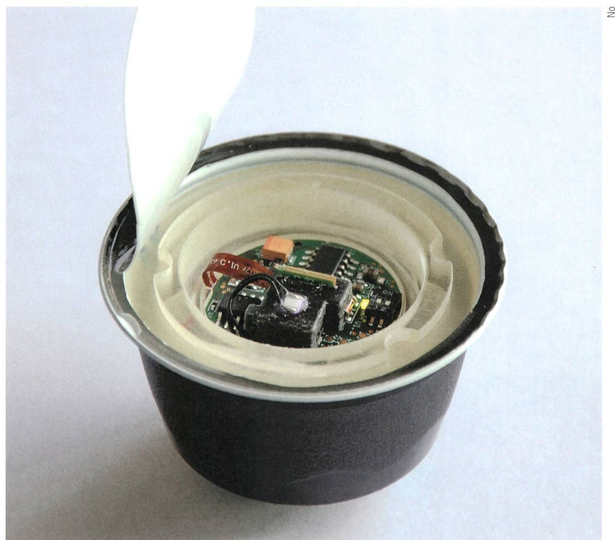
Das Sensorsystem sendet die Daten des Restsauerstoffgehalts in Echtzeit und ermöglicht so schnelle Optimierungen einer Produktionsanlage.
