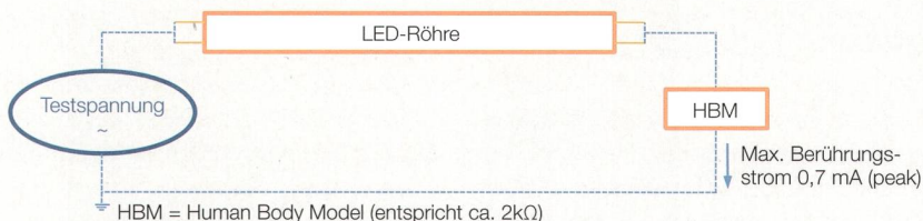
Bild 2 Schema Messung Berührungsstrom.
