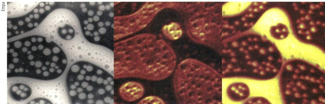
Le SFM reproduit topographiquement la surface de l'échantillon (12µm x 12µm, à gauche) alors que le TOF-SIMS met en évidence la localisation des polymères qui la constituent (au centre, les ions C<sup>-</sup> et C<sup>2-</sup> et à droite, les ions CN<sup>-</sup> et I<sup>+</sup>).
