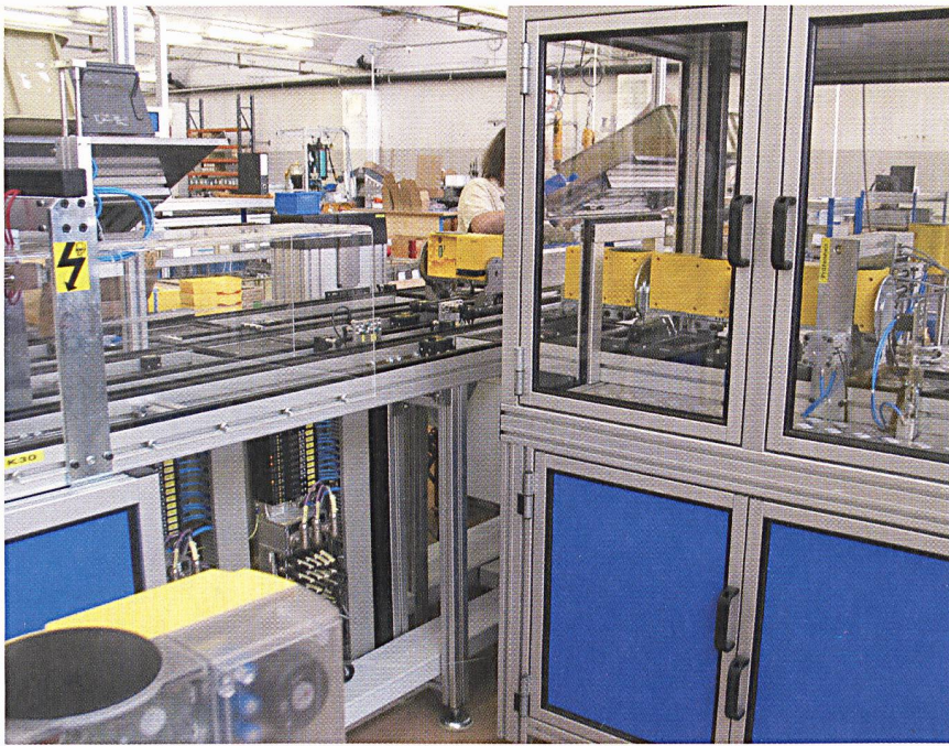
Diese Montage- und Prüflinie für Ventiltriebe ist ein typisches Anwendungsgebiet für Automatiker
