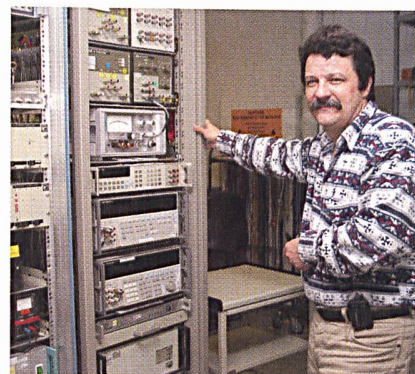
Beat Schär, Leiter Messtechnik und Kalibrierung, neben den hochpräzisen Referenzgeräten, welche periodisch vom Bundesamt für Metrologie und Akkreditierung (METAS) geprüft werden.
