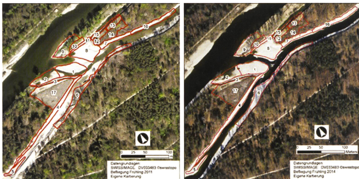
Abb. 2. Teilflächen auf Luftbildhintergrund Frühling 2011 und Frühling 2014. Die beiden Aufnahmen zeigen, dass in dieser Zeit keine grossen Änderungen erfolgt sind und die Kiesflächen weitgehend vegetationsfrei blieben. Gut sichtbar ist auch, dass das Gerinne zwischen den Teilflächen 1 und 8 bereits im Frühjahr 2012 seinen Lauf verändert hatte und zum Aufnahmezeitpunkt 2011 noch kein Wasser im südlichen Teil entlang der Teilflächen 4 und 5 durchgelassen wurde.
