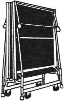
Faltbare und transportable, universell verwendbare Bühnenpodien · Auf- und Abbau in wenigen Minuten ohne Werkzeug durch 1 Mann · Lagerfläche = 1/6 der Gebrauchsfläche · Tragfähigkeit 500 kg/m<sup>2</sup> · Praktisch unbegrenzte Lebensdauer.
