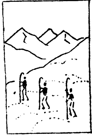
Abtasten nach Verschütteten mit Sondierstangen.
