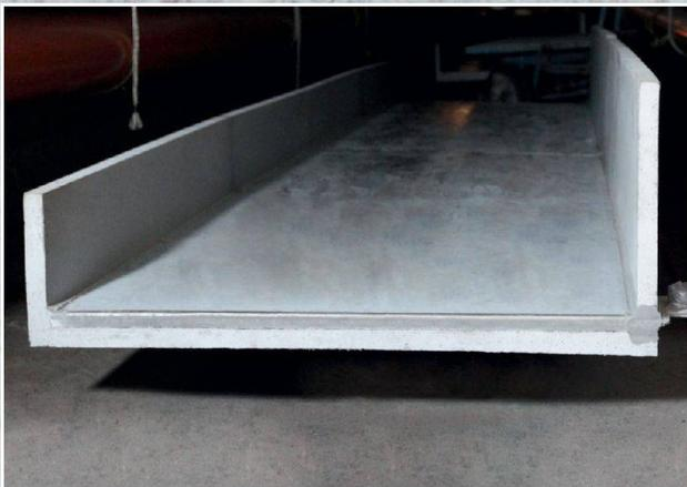
Mit diesem zukunftsweisenden Werkstoff aus Polyester und Quarzsand lassen sich Teile für die unterschiedlichsten Anwendungen formen und herstellen. 100% wasserdicht, feuer- und säurebeständig und mit einer sehr hohen Biegezugfestigkeit lässt der Werkstoff Polymerbeton minimale Wandstärken von 3 cm zu.
