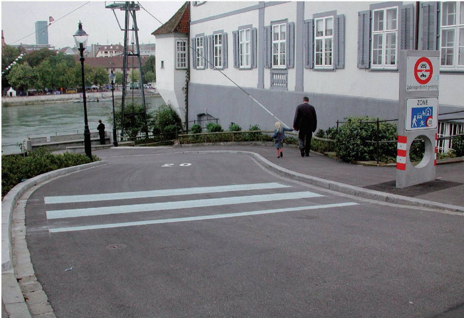
Die Ein- und Ausgänge der Begegnungszonen in Basel werden mit drei Streifen markiert. Die Wahrnehmung soll damit verbessert werden
