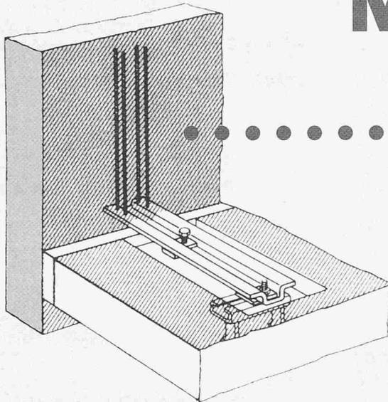
OMEGA-Brüstungsanker aus hochwertigem rostfreiem Stahl verfügen über die Rasterung für kraftschlüssige Verbindungen. Damit hat sich das Original bei Tausenden von Objekten bewährt.
