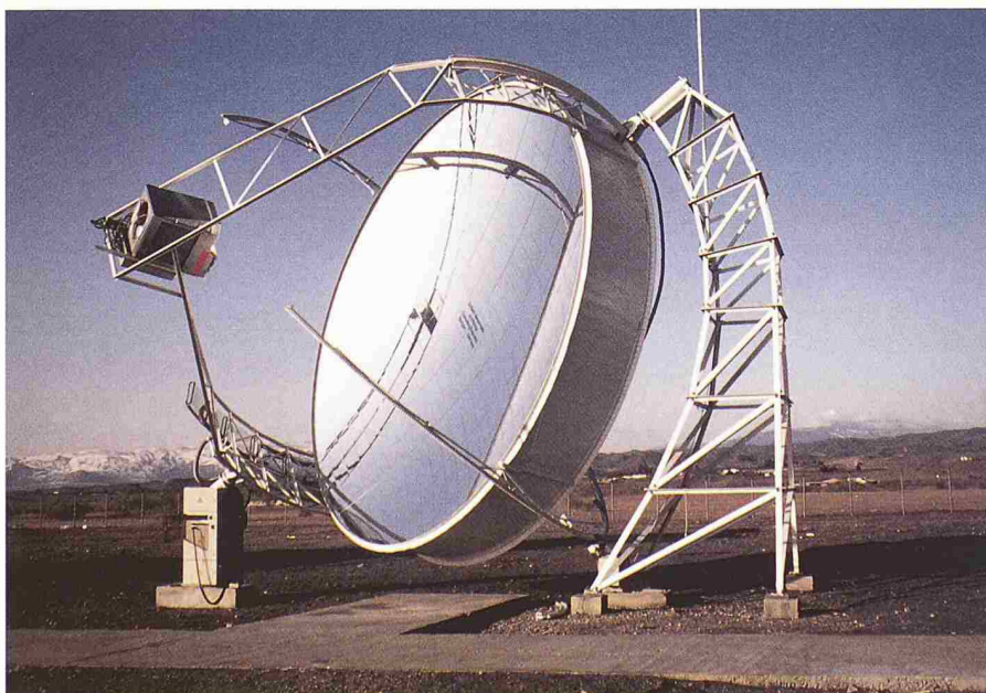
4 9 kW Dish/Stirling-Einheit auf der Plataforma Solar in Almería, Spanien, Entwicklung [5] (Bild: Schlaich Bergemann und Partner)
