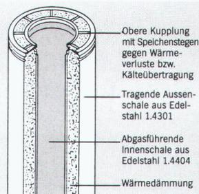
Perfekte SELKIRK Produkt-Konzeption: 3-schaliger Aufbau mit Innen- und Aussenschale aus hochwertigem Edelstahl, dazwischen der dicke Mineralwoll-Dämmstoff mit hoher Stopfdichte.
