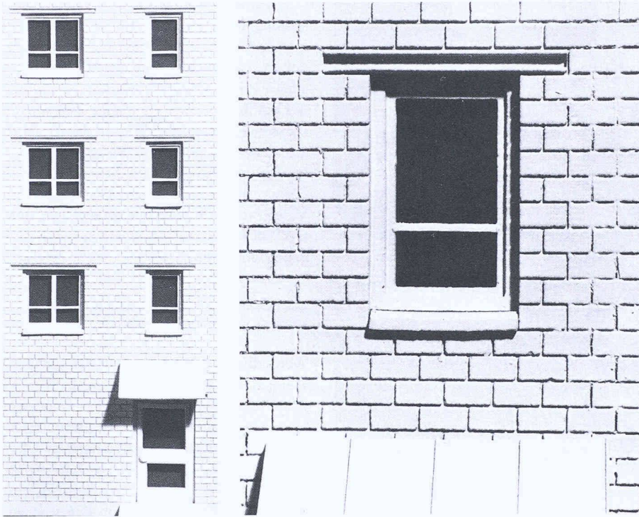
Links: Fassadenmodell Mst. 1:50, im Original 243 × 96 mm, hergestellt mittels Stereolithographie. Rechts: Ausschnitt, im Original etwa 43 × 56 mm
