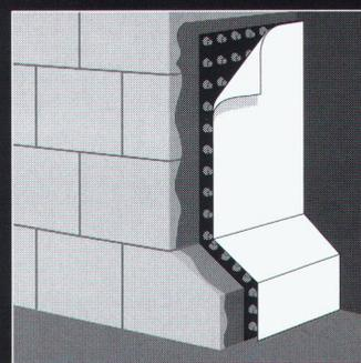
Mit einem Mauerschutz der im Erdreich allen Aufgaben gewachsen ist: **Amerdrain Kunststoff-Noppenbahnen** mit verklebtem Vlies oder Gewebe.
