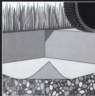
Mit einem neuen Aufbau dank dem **Armierungsgitter Hatelit®** sanieren Sie alte Strassen:
