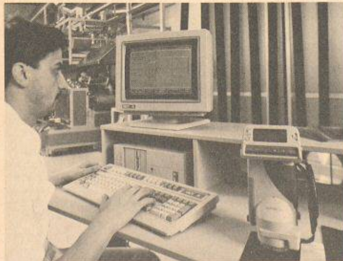
High-Tech-Farbmessung in der Storen-Industrie: Spektralphotometer und PC sorgen für optimale Farbabstimmung und Qualitätssicherung
