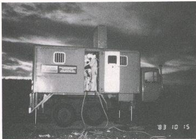
Bild 9. Drucksondierungen unter Vollatemschutz (Deponie Gersheim, Deutschland)
