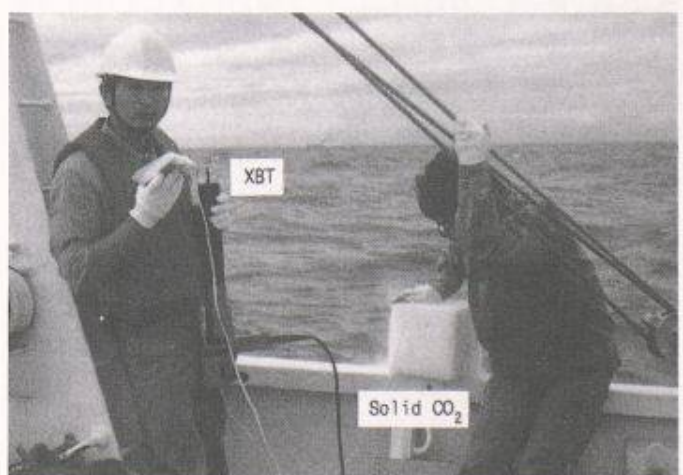
Bild 2. Feste CO 2 -Eiskuben, die auf der Kaiyo Maru zur Versenkung bereitgemacht werden (XBT-Bathysonde, ozeanographisches Messgerät) (Quelle: N. Nakashiki et al.)
