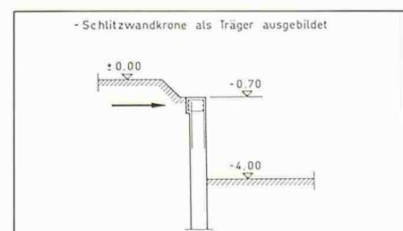
Auf der Nordseite der Baustelle wurde nun eine erste Etappe von fünf Meter über die ganze Baugrubenbreite ausgehoben. Abschluss der Aushubetappe bildete eine Böschung von sechzig Grad Neigung. Die Schlitzwandkrone wirkte nun als Auflager für die Wandelemente
