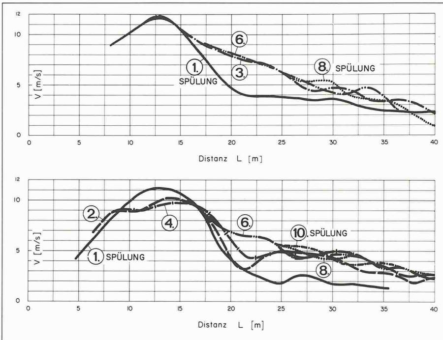
Bild 10. Geschwindigkeitsverlauf der Spülfront
