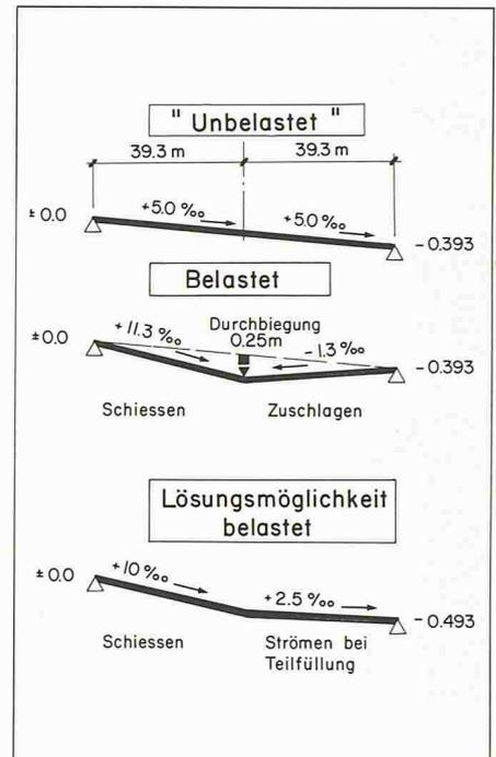
Bild 12. Auswirkung der Durchbiegung auf die Strömungsgefälle der Rohrleitung.
