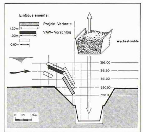
Bild 3. Schematische Darstellung der Strömung im Bereich des Steinfanges
