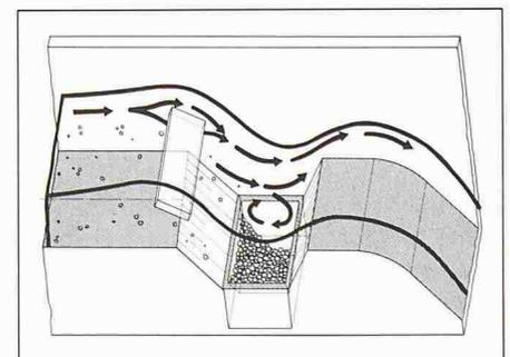
Bild 5. Dank der Traverse entsteht ein ruhigeres Strömungsbild; die Neigung der Kontaktfläche zwischen Wasser und Ablagerung wirkt günstig im Sinne der angestrebten Komponentensortierung
