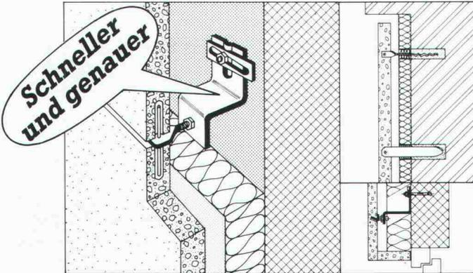
Ankersysteme für Beton und Kunststein, Naturstein, Mauerwerk aussen.
