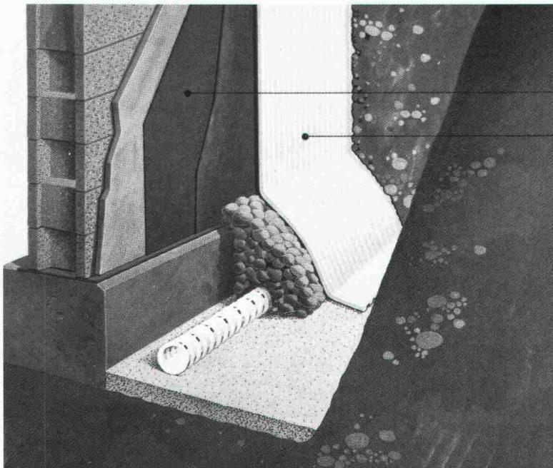
Mauerwerk mit Feuchtigkeitsisolierung
