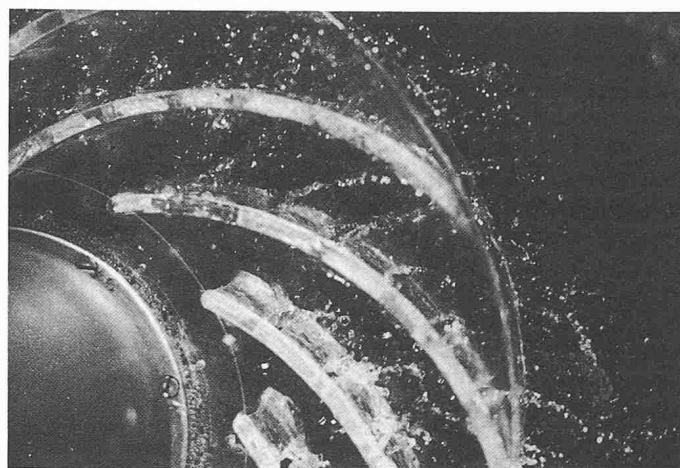
Bild 18. Photographische Aufnahme der Flüssigkeitszerstäubung im Zerstäubungsrad
