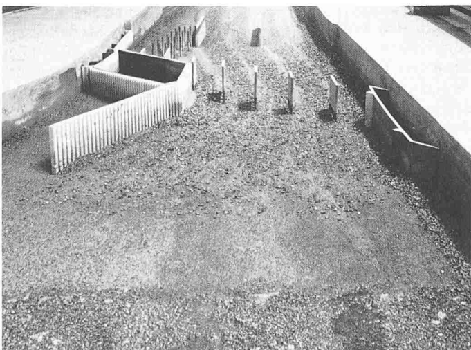
Bild 14. Kolkbild nach dem Versuch (gemäss Bild 12); maximale Kolkiefen etwa 1,60 m
