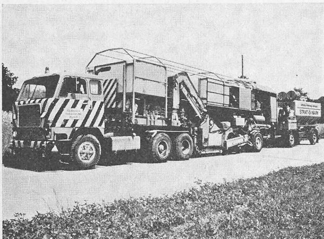
oder Betonbelag eine Nut geschliffen, wobei der Frässtaub abgesaugt und im Anhänger gesammelt wird, was von der Bedienungsmannschaft besonders geschätzt wird. Hinter der Fräse wird die Heissplastikmasse in die schleifwarme Nut eingegossen und Reflexperlen nachgestreut. Die Markierungsstriche, welche 1 oder 2 cm in die Strassendecke eingelassen werden, können unmittelbar nach dem Verlegen überfahren werden. Dadurch ist die Verkehrsbehinderung auf ein Mindestmass beschränkt.
