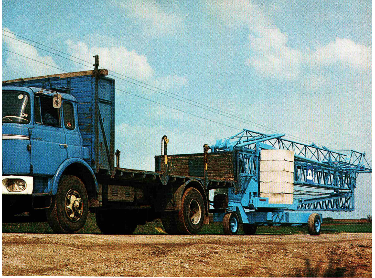
Vorne haben sich die 10 Ausgleichgewichtsblöcke nicht verschoben.
