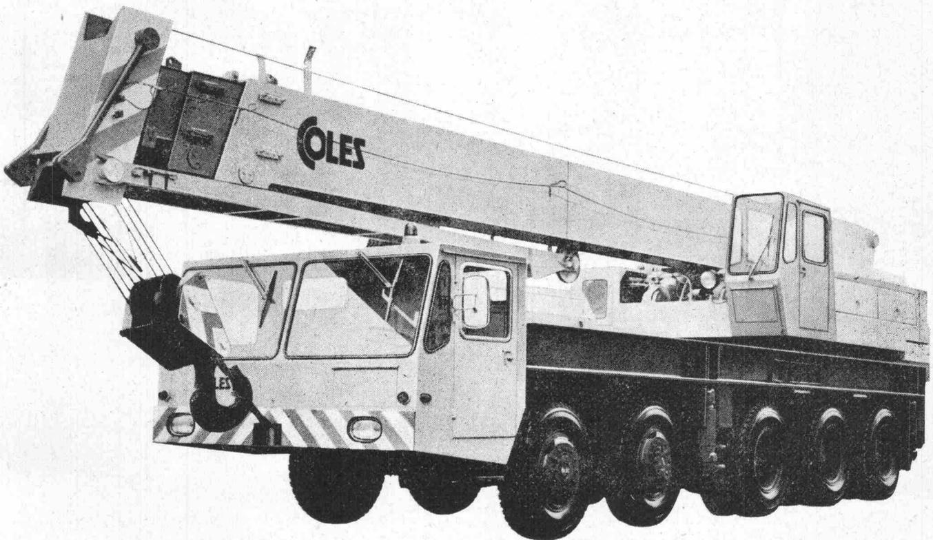
COLES L45 Autokran, Tragkraft 45 t, Hakenhöhe 53 m
