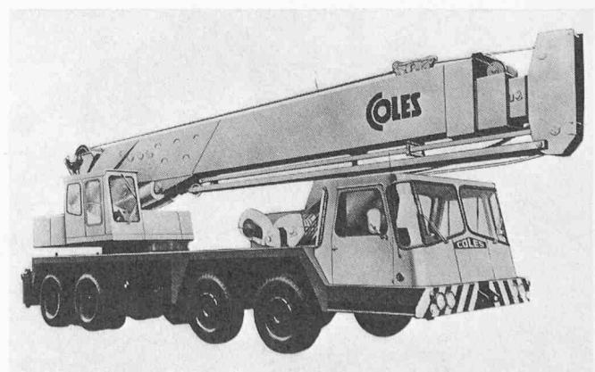
Bild 2. Schwerer Autokran mit vollhydraulischem Teleskopausleger bis 28 m Länge; Tragfähigkeit 34 t.
