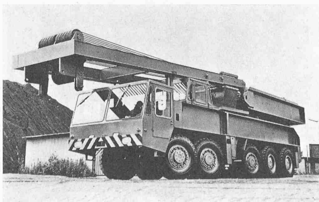
Bild 1. Dieselelektrischer Autokran mit einer Tragfähigkeit von 125 t bei 4,5 m Radius und 18 m Hakenhöhe
