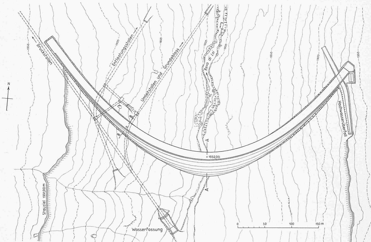
Bild 4. Die Staumauer Lei, Grundriss 1:4000
