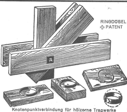
Knotenpunktverbindung für hölzerne Tragwerke
