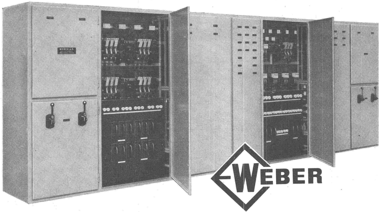
Hauptverteil- und Schützenschrank in staub- und spritzwasserdichter Ausführung, für einen Papiermaschinen-Antrieb mit 30 Motoren einer Papierfabrik.
