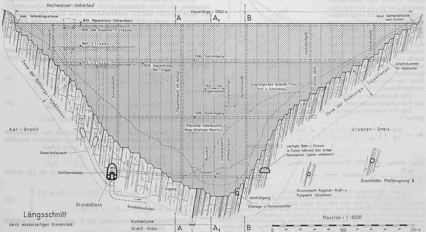
Abb. 6a. Staumauer Schöllenen, Längsschnitt 1:3000
