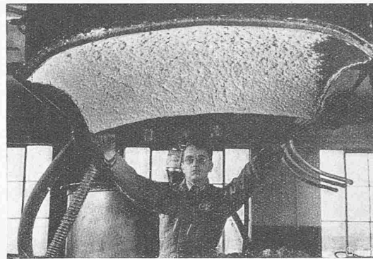
Abb. 2. Rohform eines Dachteiles. Der Kunstharzbrei mit Holz- und Pflanzenfasern vermischt, wird durch Vakuum an ein Drahtgeflecht angesogen und dadurch weitgehend entwässert. Nach Aufhebung des Vakuums wird die Rohform frei und kann in die Presse gelegt werden, wo sie unter Druck und Wärme auf \frac{1}{4} ihrer Dicke verdichtet wird
