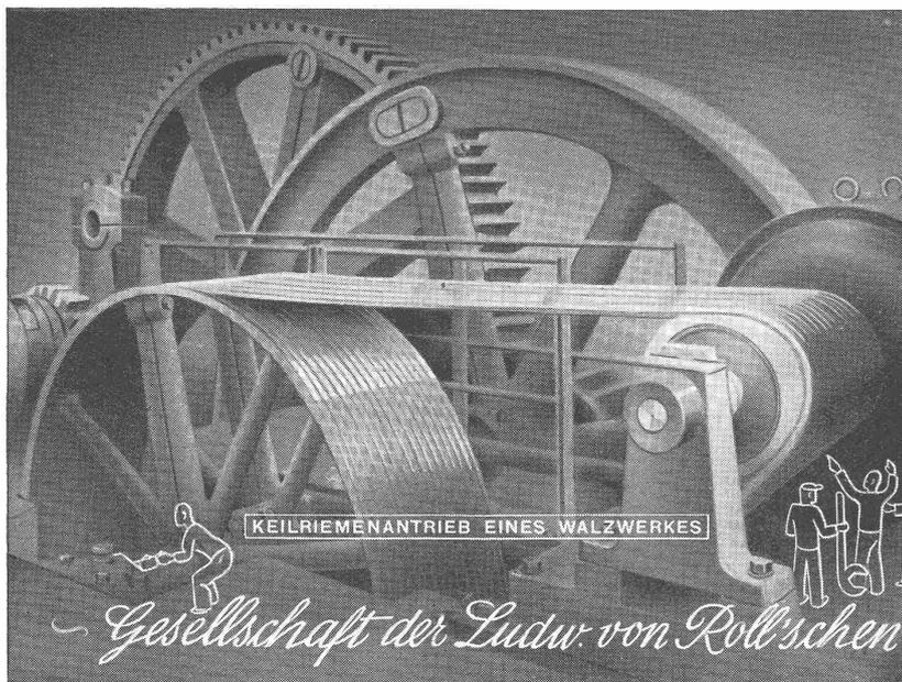
KEILRIEMENANTRIEB EINES WALZWERKES
