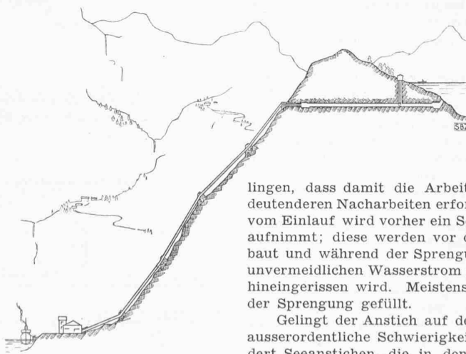
Abb. 1. Typisches Wasserkraftwerk an der Westküste Norwegens
