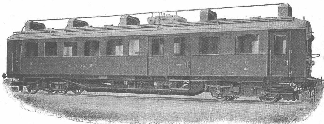
Benzin-Triebwagen der Bodensee-Toggenburg-Bahn
