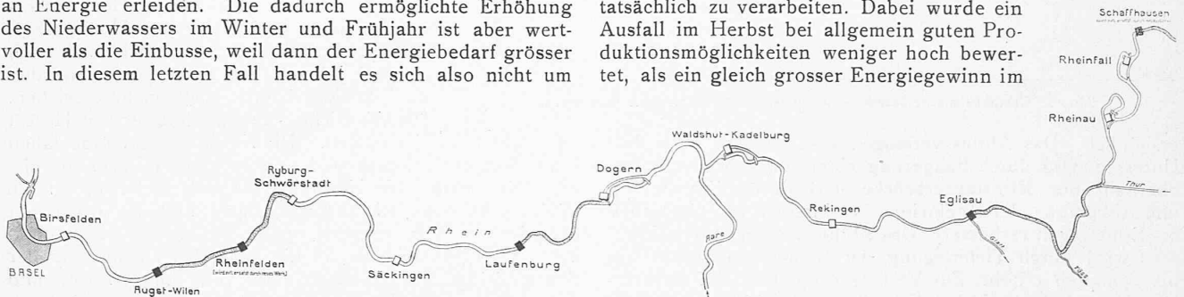
Abb. 8. Uebersichtskizze der bestehenden und der projektirten Oberrhein-Kraftwerke (Ryburg-Schwörstadt befindet sich im Stadium des Baubeginns).
