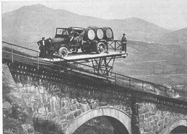
Abb. 2. Wagen mit Plattform für Automobiltransport.
